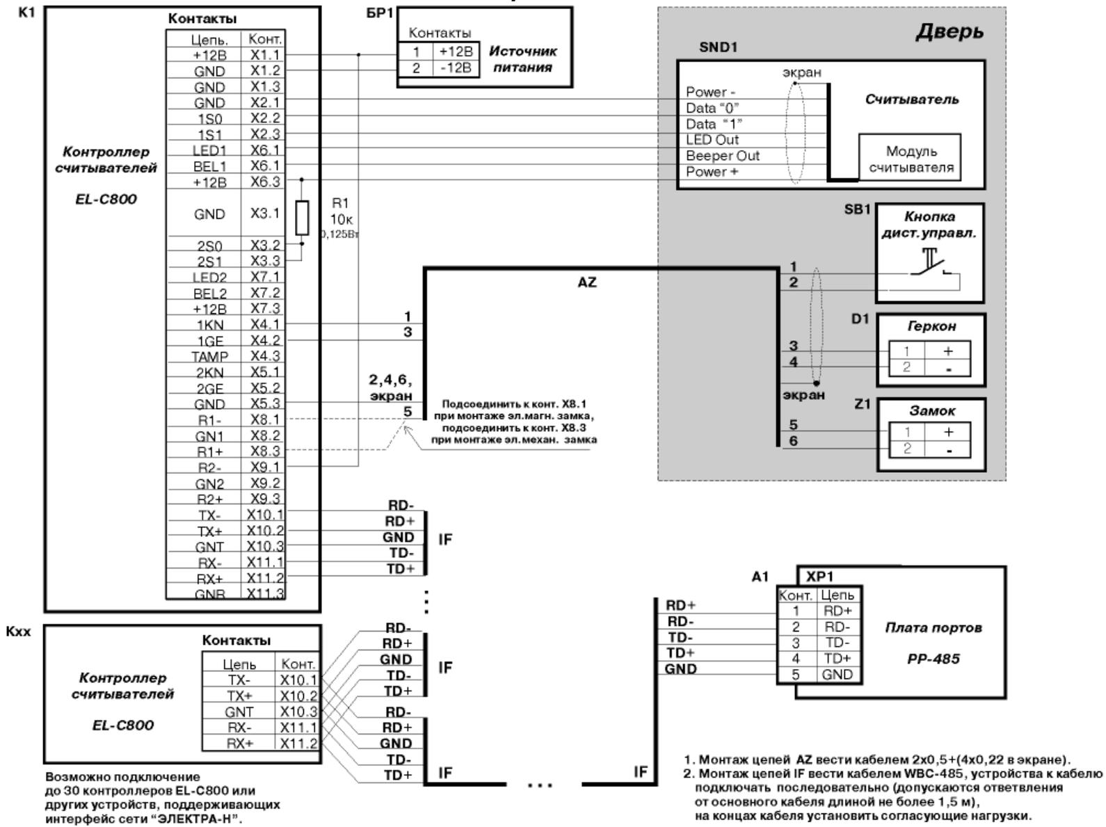
Схема управления доступом на базе контроллера EL-C800
