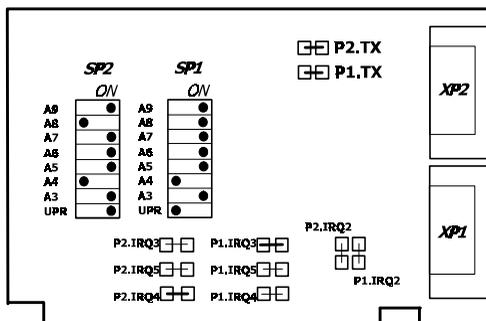
Выходные сигналы снимаются с портов **P1** и **P2**. Установка базовых адресов, номеров прерываний и режимов работы портов осуществляется DIP-переключателями и перемычками.
