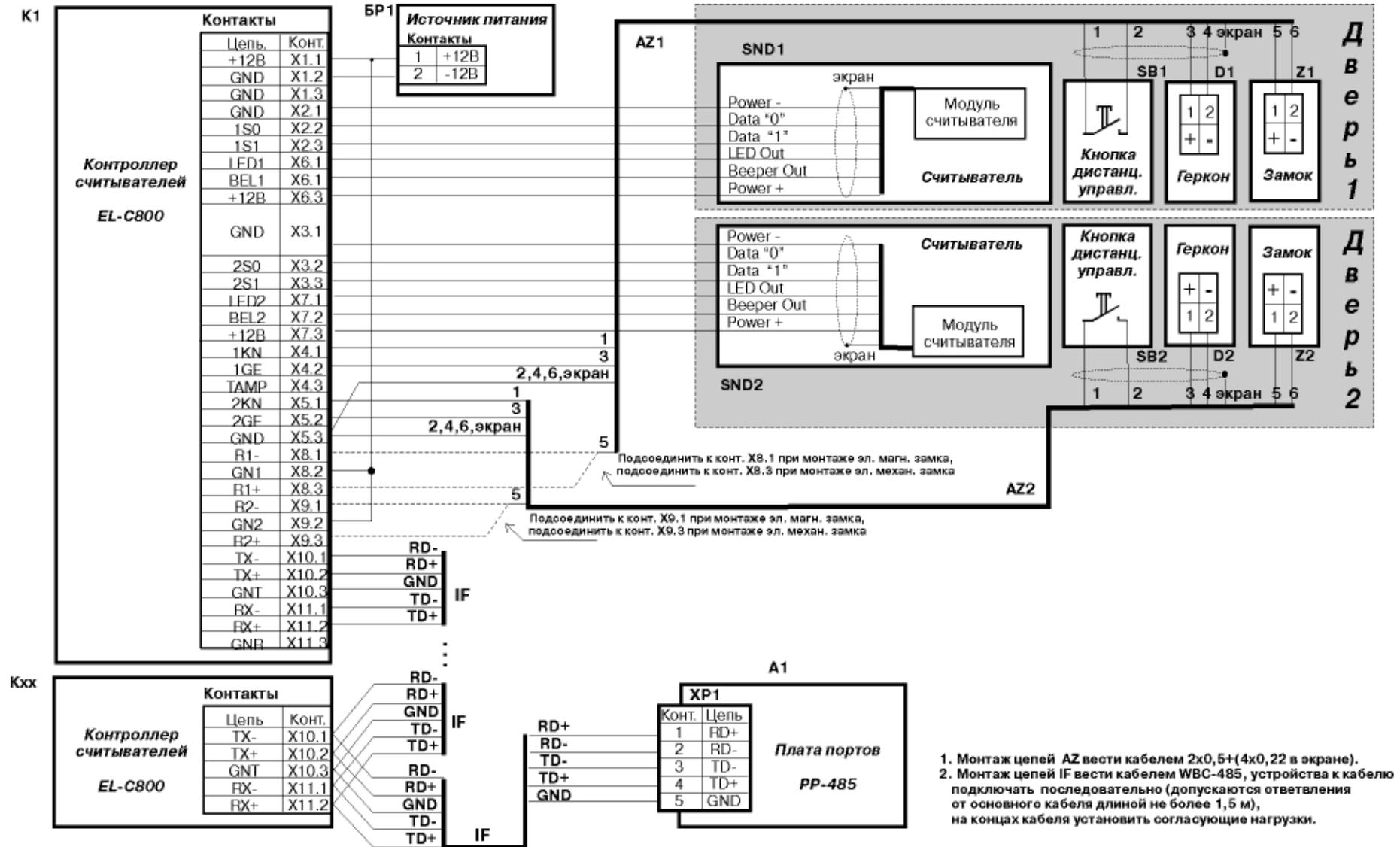
Возможно подключение до 30 контроллеров EL-C800 или других устройств, поддерживающих интерфейс сети "ЭЛЕКТРА-Н".
