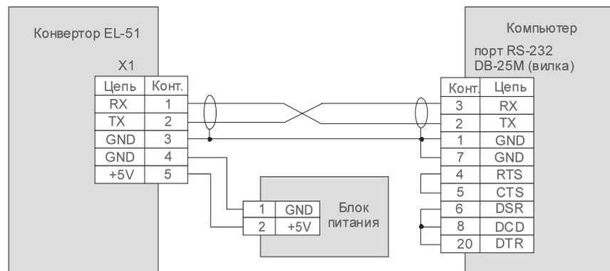
б) Вариант с разъёмом DB-25M
